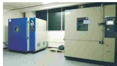
Камера испытаний на воздействие низкого давления (слева) Камера испытаний на продолжительное воздействие температур и влажности (справа)
