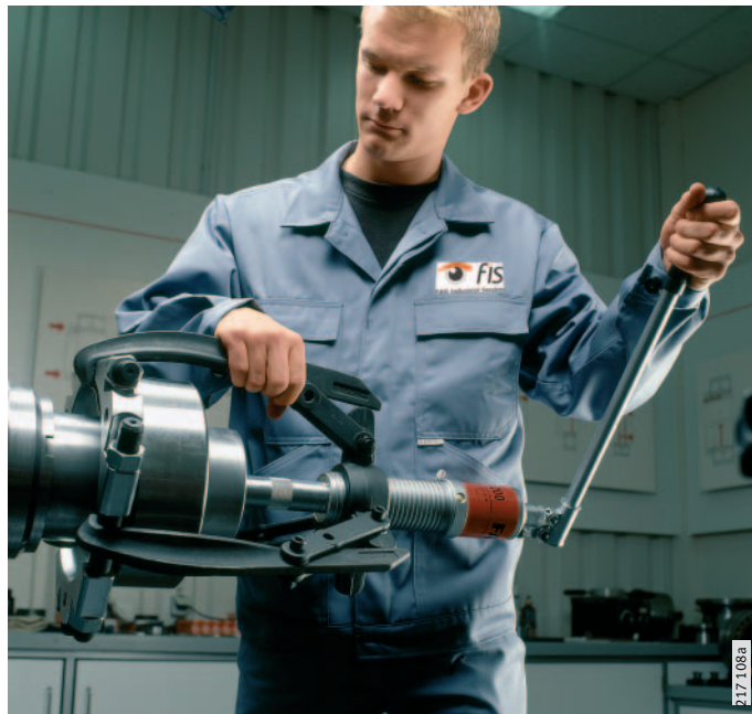
Рисунок 1 Демонтаж подшипника с помощью гидравлического съемника
