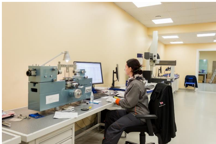
Длинномер LMI 01-400 PC-MA (ЕКМ Jena GmbH, Германия)
