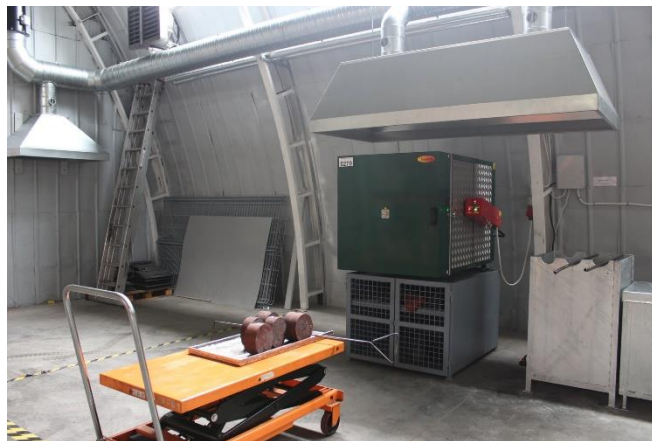
Печь КРМ120/1200 для закалки и отпуска деталей
