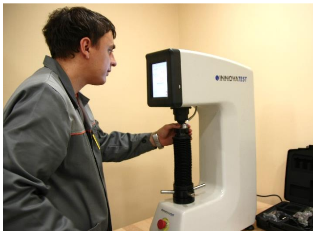
Твердомер INNOVATEST NEXUS 610 RSB (INNOVATEST Europe BV, Нидерланды)
