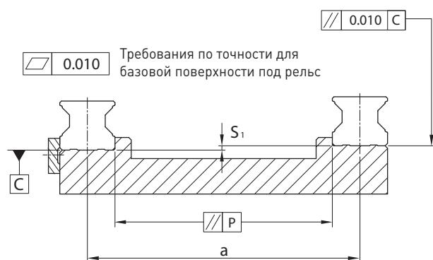
Табл. 2-7-22 Max. допуск параллельности (P)
