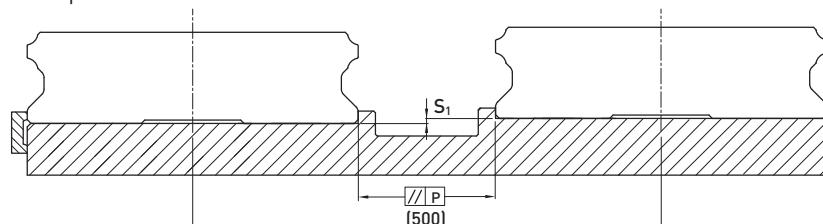
Табл. 2-5-14 Max. допуск параллельности (P)
