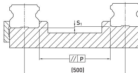
Табл. 2-2-16 Max. допуск параллельности (P)
