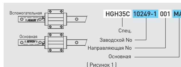
3. Определение базовой поверхности: базовая поверхность (B) направляющей это сторона, указанная стрелкой, которая промаркирована на верхней поверхности рельса. Базовая поверхность каретки - гладкая поверхность каретки, указанная как D на рисунке 2.
