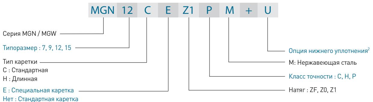
○ Маркировка направляющей серии MG
